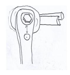
Puis on repère là où tombe l'axe fixé au boitier de pédalier et l'on perce un second trou (normalement à 38mm de la vis de manivelle On vient visser la seconde manivelle sur l'axe fixé au boitier de pédalier avec la dernière vis longue. Voilà le principal du mécanisme assemblé!
